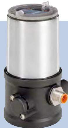
Kompakter Stellungsregler zum integrierten Anbau an pneumatisch gesteuerte Prozessregelventile. Die Sollwertvorgabe erfolgt über Normalsignal 4-20 mA. Ein kontaktlos arbeitendes Sensorelement erfasst die Position der Ventilspindel.
