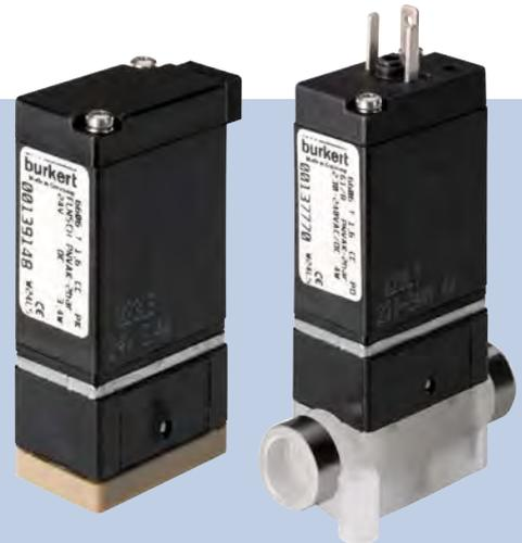
Das direktwirkende Wippen-Magnetventil Typ 6606 (2/2- und 3/2-Wege) besitzt ein minimales Totvolumen und eine spaltarme, leicht zu spülende Innenkontur. Das Medium kommt ausschließlich mit dem Gehäusewerkstoff und der Dichtung in Berührung. Der Wärmeeintrag ins Medium ist minimal, da das Gehäuse von der Spule zusätzlich durch eine Edelstahlplatte abgetrennt ist. Das Ventil ist insbesondere zum Dosieren, Füllen, Mischen und Verteilen kleiner Mengen aggressiver Medien optimal.
